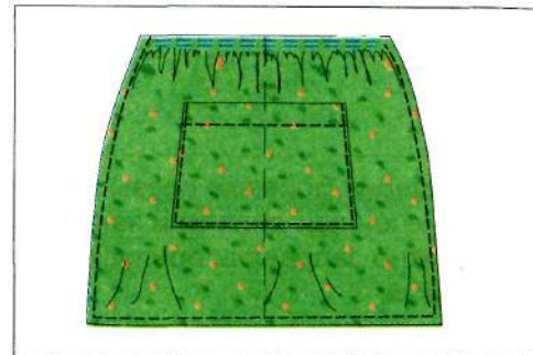
Рис. 28. Распределение сборки по ширине
