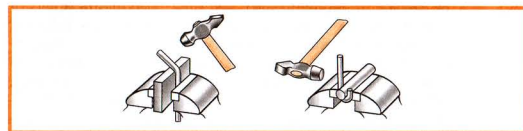
Рис. 80. Гибка толстой проволоки в тисках
