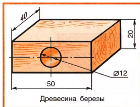
Рис. 14. Технический рисунок детали
