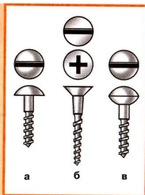
Рис. 39. Шурупы с различными головками: а — полукруглой; б — потайной; в — полупотайной
